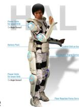
Très impressionnant, ce robot intègre des capteurs chargés de recevoir les signaux de mouvements musculaires du cerveau, pour ensuite les retransmettre et animer des micro-moteurs qui permettront à la personne qui en est équipée de marcher, de monter les escaliers, de s'asseoir, ou encore de porter une masse avec le minimum d'effort. Elle augmenterait de cinq fois notre force selon son créateur ! Une vidéo de démonstration est disponible ici : <http://fr.youtube.com/watch?v=G4evlxq34og>
